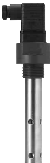
29. ábra Mérőcella konduktív vezetőképesség méréshez
